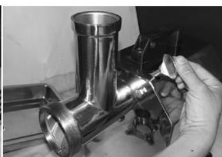
Rys.5. Wyjąć ślimak; uważać, aby nie zgubić nylonowej podkładki.
