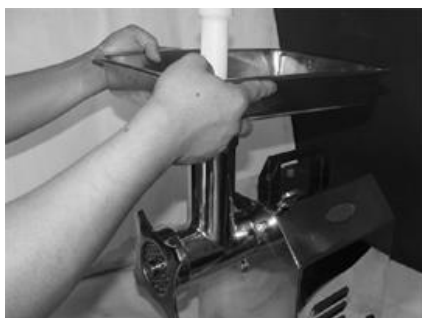
Rys.1. Zdjąć tackę na mięso , jednocześnie przekręcając i pociągając ją do góry
