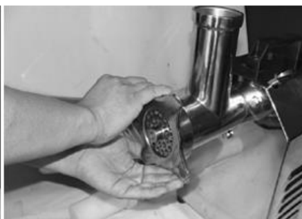
Rys.2. Odkręcić nakrętkę blokującą
