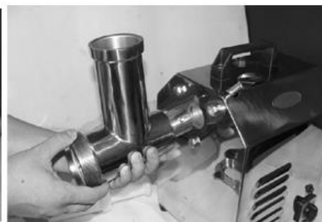
Rys.6. Zdjąć całą gardziel, przytrzymując urządzenie podczas odkręcania nakrętek blokujących
