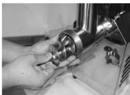
Rys.4. OSTROŻNIE zdjąć ostrze tnące, uważając na ostre krawędzie
